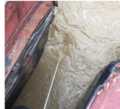
Plongé dans l'eau et relevé tous les mois, la phase absorbante est analysée et permet d'obtenir une moyenne de la contamination accumulée et ce pendant un an
