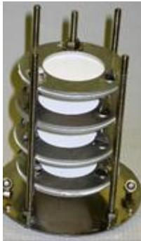
Appareil équipé d'une phase absorbante maintenue entre deux membranes qui permettent d'accumuler certains micropolluants
