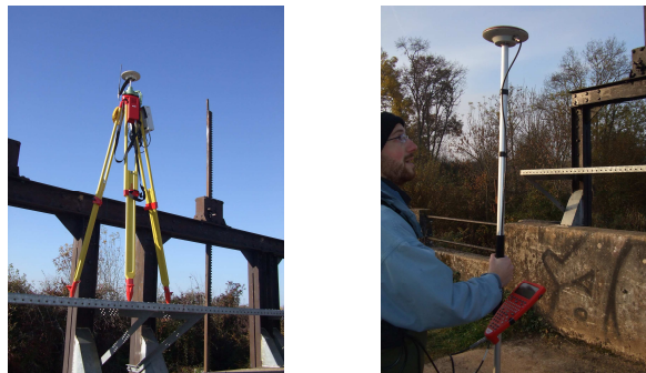
Photo 47 : Station de référence du GPS différentiel installé sur les portes à flots (photo de gauche) et pivot mobile (photo de droite). Source : MIGA.DO.
